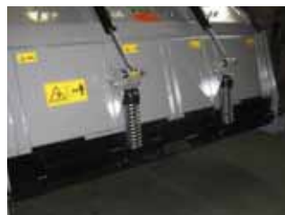
Задний защитный гидравлический щиток с функцией выравнивания материала на выходе.
