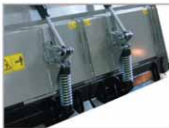
Задний гидравлически регулируемый защитный щиток с функцией выравнивания материала на выходе
