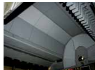
Внутренние элементы защиты из специальной стали HARDOX® легко заменяемы и обеспечивают повышенную износоустойчивость.
